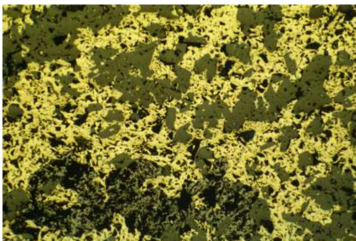
Рис. 4.12 - Халькопирит, выполняющий роль цемента обломков вмещающей оруденение породы. Внизу располагается вытянутый агрегат магнетита (темно-серый, ноздреватый)
