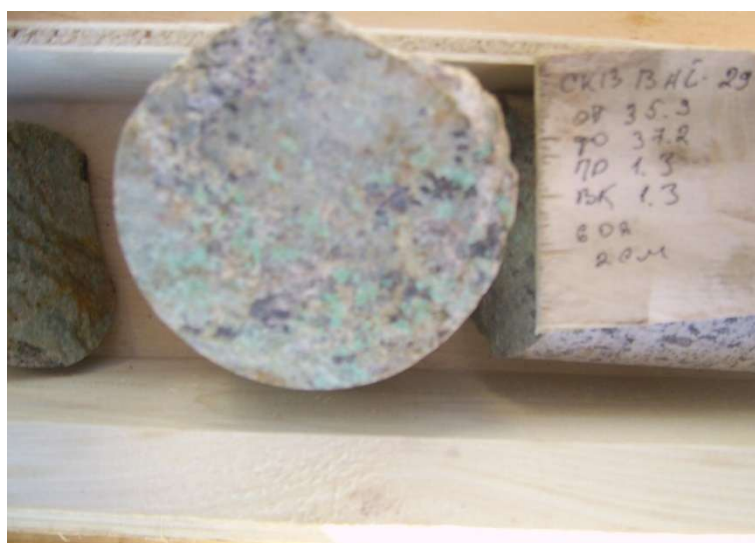
Рис. 4.4 - Малахитовые руды в гранодиоритах, по вкрапленным сульфидным рудам
