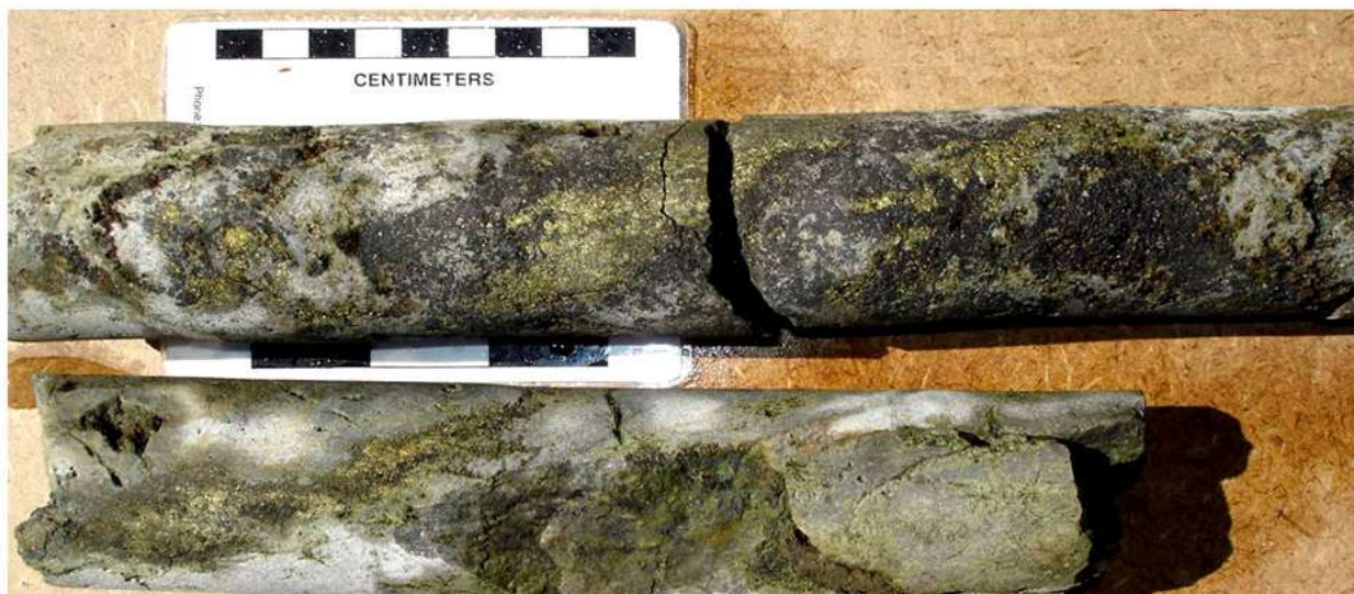
Рис. 4.8 - Кварц-сульфидное жильное образование с халькопиритом пиритом, борнитом и вторичным халькозином. Скважина ВА1-9, глубина 57,0 м; медь - до 7,2%; золото - 0,3 г/т.
