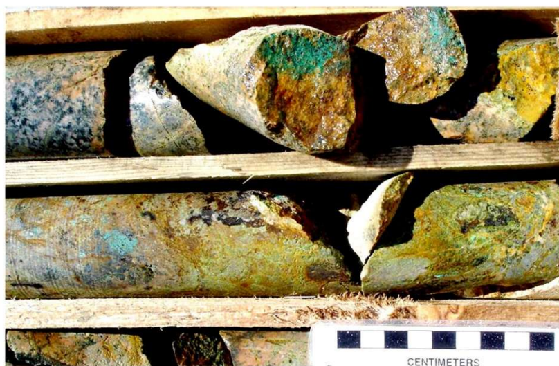
Рис. 4.3 - Смешанные руды с малахитом по кварц-сульфидной жиле. Содержание меди в пробе-1,4%. Скважина ВАІ- 9, глубина 27,5 м
